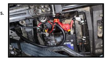
RUN THE POWER WIRE DOWN THE DRIVER SIDE MIDDLE BAR OF THE ROLL CAGE. BATTERY IS UNDER THE DRIVER'S SEAT. INSTALL THE FUSE HOLDER AND CONNECT THE BATTERY.
